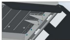
14. Материал фиксаторов капота заменен на более эластичный для предотвращения их разрушения.
